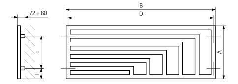
A- высота B- ширина C1-C5- расстояние между осями подключения D- расстояние между осями крепежей по горизонтали E- расстояние между осями крепежей по вертикали E- расстояние от оси нижнего крепежа до нижнего края коллектора
