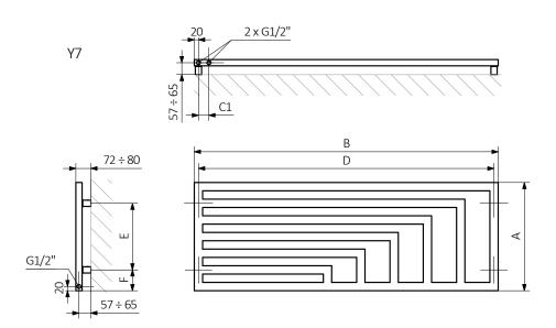
A- высота B- ширина C1-C5- расстояние между осями подключения D- расстояние между осями крепежей по горизонтали E- расстояние между осями крепежей по вертикали E- расстояние от оси нижнего крепежа до нижнего края коллектора
