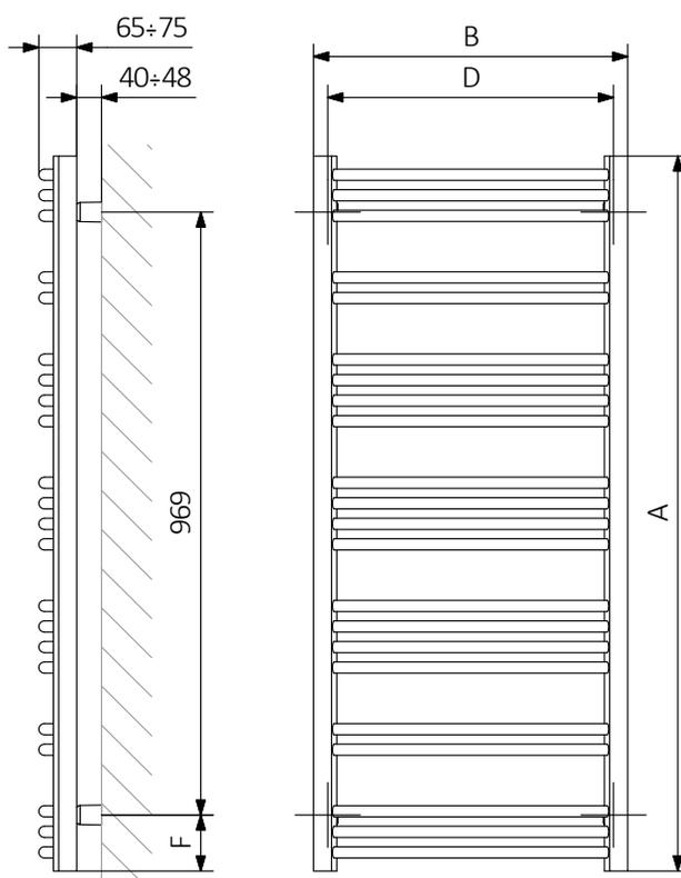
A – высота B – ширина C1-C5 – расстояние между осями подключения D – расстояние между осями крепежей по горизонтали E – расстояние между осями крепежей по вертикали F – расстояние от оси нижнего крепежа до нижнего края коллектора
