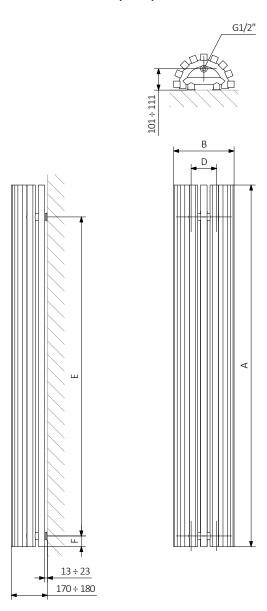
A- высота B- ширина C1-C5- расстояние между осями подключения D- расстояние между осями крепежей по горизонтали E- расстояние между осями крепежей по вертикали E- расстояние от оси нижнего крепежа до нижнего края коллектора
